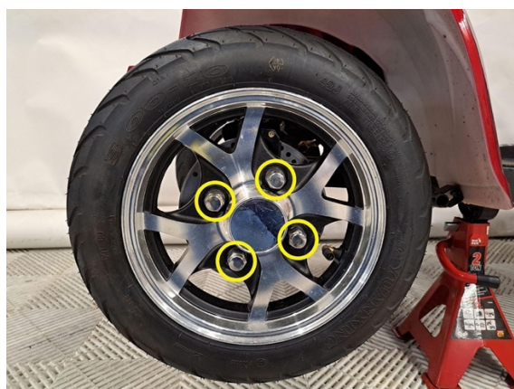
Irrota etupyörän kiinnitysmutterit. (hylsy 19 mm).
