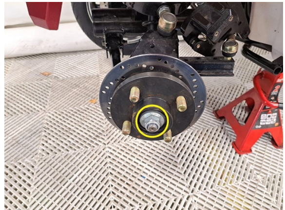
Irrota etupyörännavan kiinnitysmutteri. (hylsy 22 mm).
